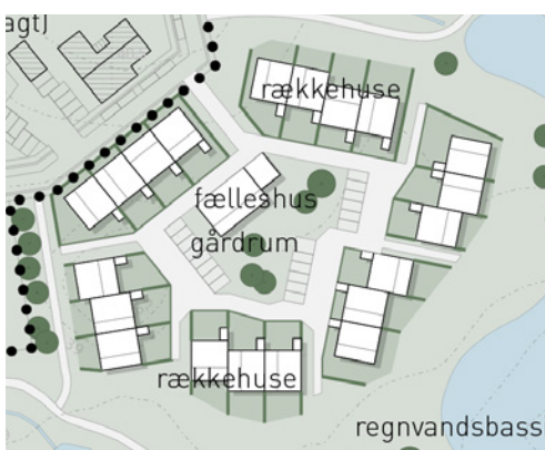
Fig.18. Udsnit af illustrationsskitse, kortbilag 3. Eksempel på, hvordan boligbebyggelsen er placeret i randen af boligenklave I.8 og på den måde danner et indre, grønt gårdrum. En placering som lokalplanen stiller krav om. © Roskilde Kommune
