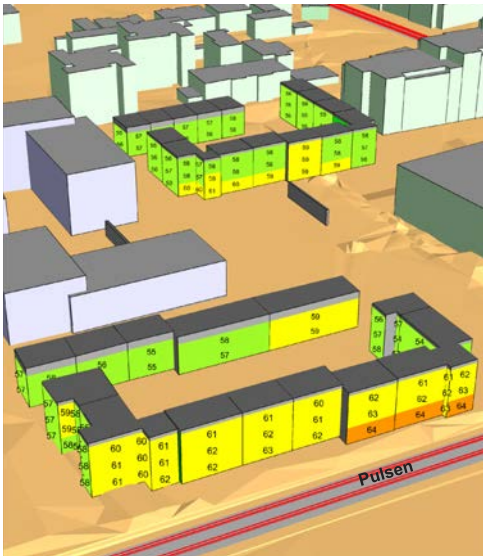
Fig.31. Beregnet vejstøjbelastning, Lden i dB, på facader mod Pulsen © Gade og Mortensen
