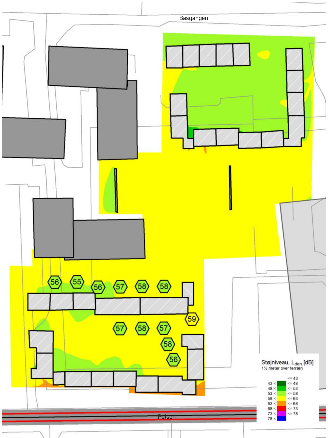
Fig.30. Støjberægning for et fuldt udbygget plan. Bebyggelsen er udformet således, at den skærmer de udendørs opholdsarealer for støj fra omkringliggende veje. © Gade og Mortensen
