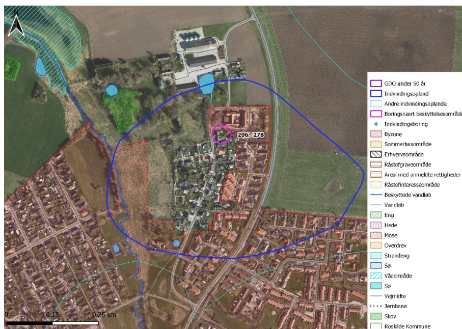
Figur 0-328 Arealanvendelse inden for indvindingsoplandet til Viby Dals Vandværk - Gl. Viby. Bemærk, at BNBO er beregnet ud fra en fejlagtig boringsplacering. BNBO skal derfor genberegnes.
