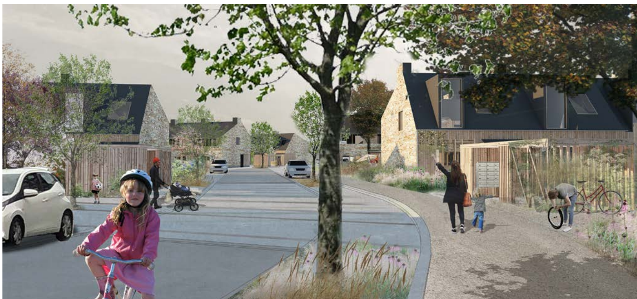
Fig. 19. Visualisering af adgangsvej A-A med fællessti på den ene side af vejen. Parkeringsbåserne placeres skiftevis i hver side af vejen og brydes med pauser af vejbede og træbeplantning. © Vandkunsten
