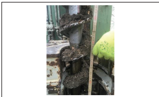
Foto 7: Boresneglen ifm. gennemboring af olietønden (dybde 1,40 m).
