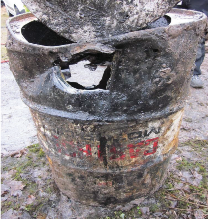
Metal tromle med synligt borehul (indgang/udgang) samt mindre tæringshuller
